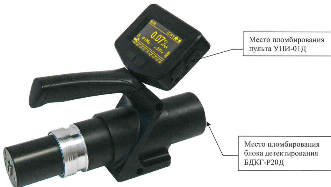
Рисунок 1 – Общий вид дозиметра-радиометра с держателем и схема пломбировки от несанкционированного доступа
